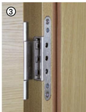
3 Türblatt so unterkeilen, dass sich die Flügellappen im Türblatt, in der Höhe, mittig zu dem Aufnahmeelement befinden. Flügellappen zwischen den Klemmplatten (wo vorher der Kunststoffeinsatz war) hinein schieben.
