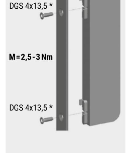
\* DGS-Gewinde für Direktverschraubung in Druckguss und Duroplaste (Schrauben im Lieferumfang)
